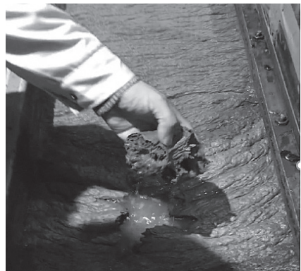
写真-4 NCL により改質し塗装ブースに浮遊した塗料スラッジ
