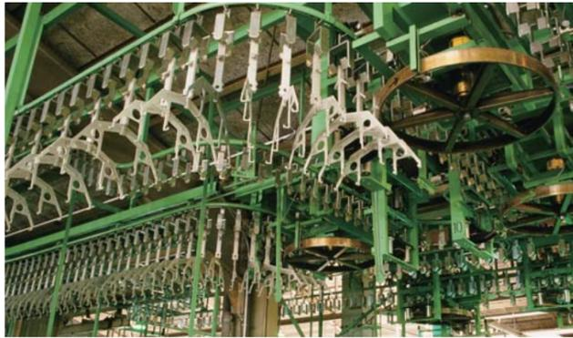
● ターン・テーブル型トロリー間移載装置
