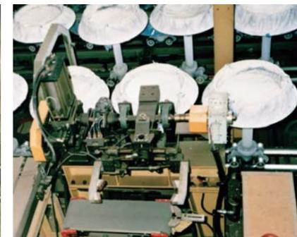
● フローア・コンベヤー間反転式移載装置
