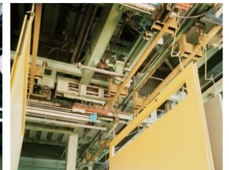
● トロリー・コンベヤーへの移載装置
