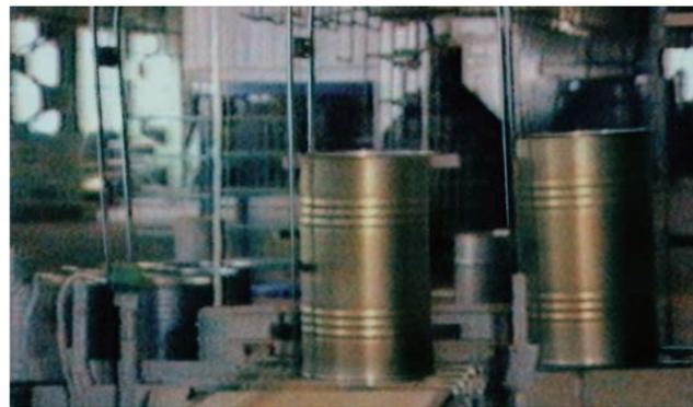
● フローア・コンベヤーからオーバーヘッド・コンベヤーへの移載装置
