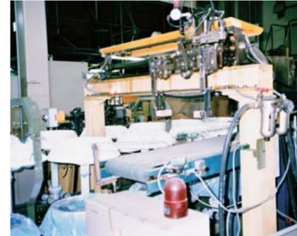
● トロー・コンベヤーからベルト・コンベヤーへの移載装置
